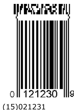
Slika 7.8.6.3–2. Primer mešoviti GS1 simbologija (GTIN je kodiran u UPC-E, a datum „Najbolje upotrebiti do“ u kompozitnom)
