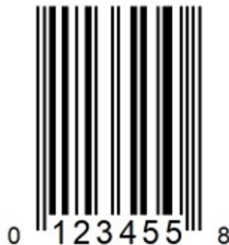
Slika 5.2.2.4-1. UPC-E bar kod (kodiranje 001234000058 sa uklanjanjem nula)
