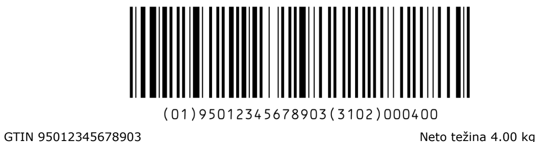
Slika 7.8.6.1–2. Podaci kodirani u jednom spojenom GS1-128 simbolu
