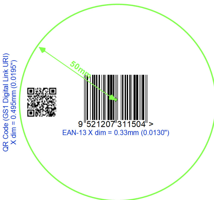
Slika 6.3.3.1-2. Primer postavljanja 2D bar koda u odnosu na linearni bar kod
