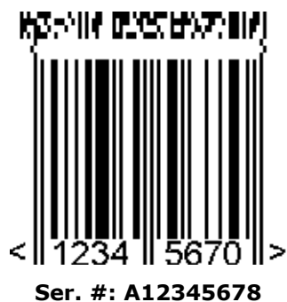
Slika 5.11.8-3. EAN-8 simbol sa CC-A komponentom sa tri kolone
