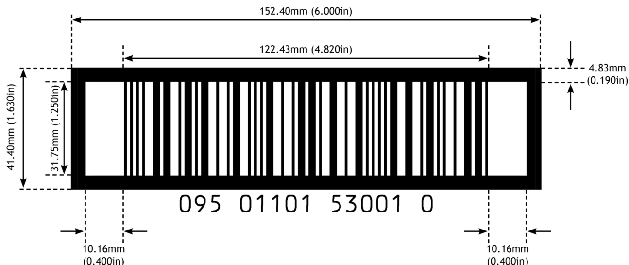
Slika 5.3.6–1. ITF-14 simbol: glavne dimenzije simbola za X-dimenziju 1,016 mm (0,0400 in)
