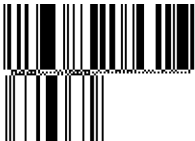
Slika 7.8.6.3–1. Primer GS1 DataBar proširenog naslaganog bar koda gde se koristi spajanje
