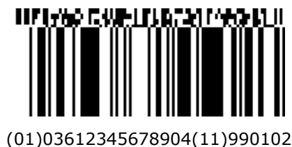
Slika 5.11.8-6. GS1 DataBar-14 naslagani simbol sa CC-A komponentom sa dve kolone
