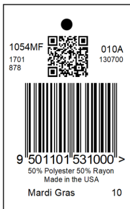
Slika 6.3.3.1-4. Primer postavljanja 2D bar koda maksimalne POS X-dimenzije u odnosu na linearni bar kod
