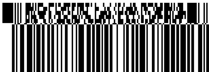
Slika 5.11.2–2. GS1-128 kompozitni simbol sa CC-C
