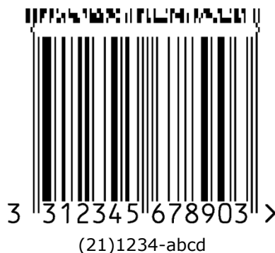
Slika 5.11.8–1. EAN-13 simbol sa CC-A komponentom sa četiri kolone
