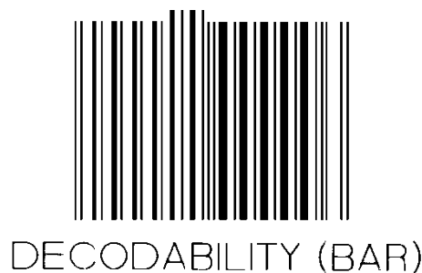
Slika 5.12.5.12-3. Simbol za kalibraciju sa zadatom niskom ocenom mogućnosti dekodiranja
