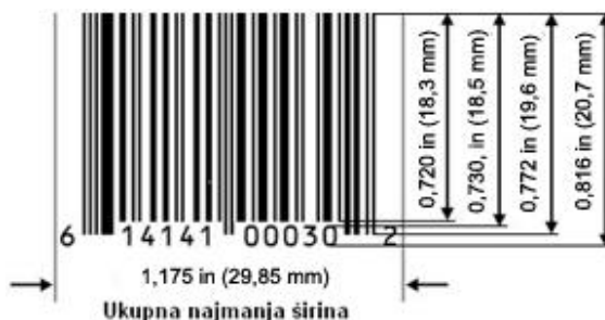
Slika 5.12.6.3–1. EAN/UPC simbol prikazan sa najmanjem visinom i ukupnom dimenzijom za širinu za uvećanja od 75% do 80%
