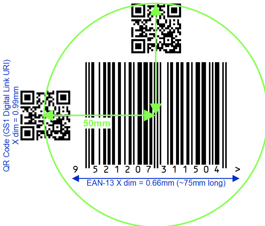
Slika 6.3.3.1-4. Primer postavljanja 2D bar koda maksimalne POS X-dimenzije u odnosu na linearni bar kod
